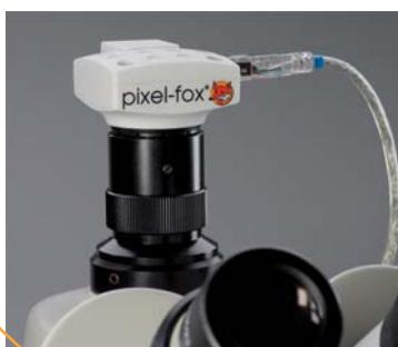
Zum pixel-fox® Paket gehört eine Digitalkamera, die an alle handelsüblichen Mikroskope, Makroskope, Endoskope, Objektive usw. montiert werden kann, einen entsprechenden C-Mount-Adapter vorausgesetzt. Eine hohe Auflösung sorgt dafür, dass Ihre Bauteile, Proben und Präparate immer detailliert und präzise dargestellt werden. Stromversorgung und Datenübertragung laufen bequem über ein einziges Kabel – kein separates Netzteil, kein Kabelsalat!
