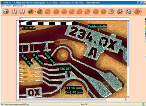
2D-Vermessung per Software: Umfassende Messmöglichkeiten, klare grafische Darstellung, einfaches Handling – incl. Kalibrierfunktion, Maßstabsbalken und Beschriftungen.
